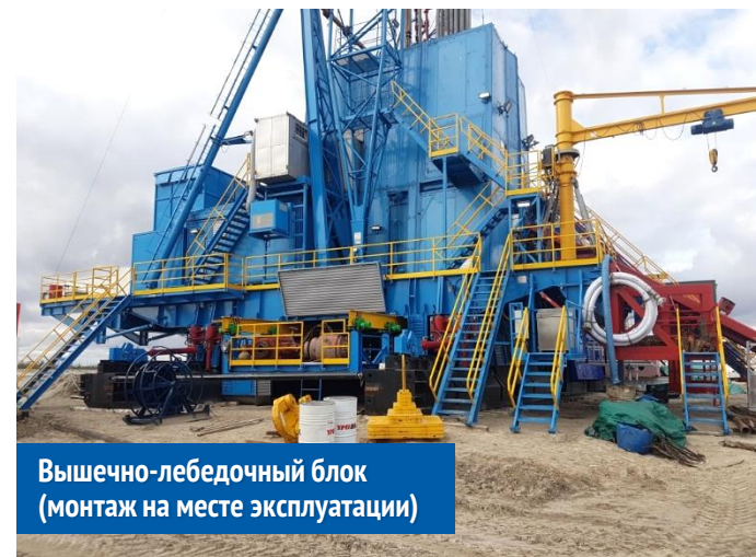
Укрытия низа вышечно-лебедочного блока
