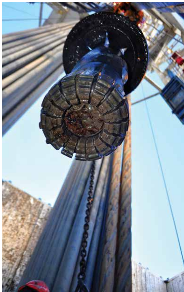
Отбор керна на скважине №2503 Висового месторождения (НАО) для ООО «СК «Русьветпетро»
